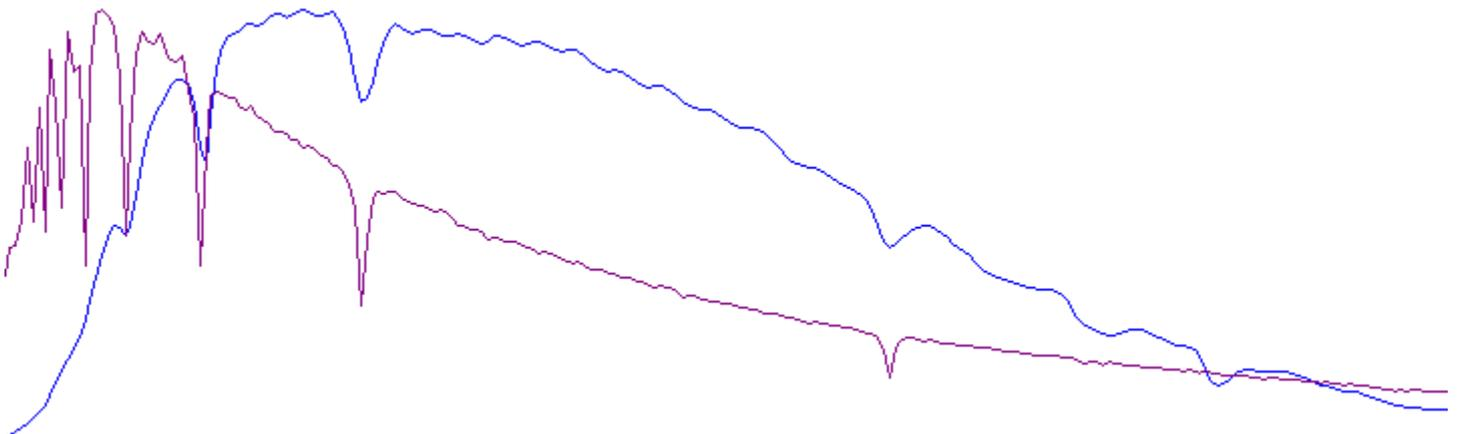
La raie assez large présente dans notre spectre sur la droite et qui n'est pas présente sur le spectre de référence ne doit pas nous inquiéter. On verra plus loin qu'il s'agit d'une raie produite par l'oxygène moléculaire de notre bonne vieille atmosphère (et qui donc n'a pas à figurer sur le spectre de référence!).
