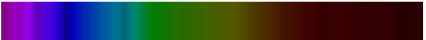
En conclusion, on voit donc qu'avec un simple réseau placé devant une caméra CCD, on peut obtenir la forme générale du spectre caractéristique d'un type d'étoile ainsi que ses raies les plus prononcées.
