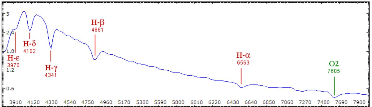
La raie la plus à droite du spectre correspond à une raie *tellurique*, c'est à dire à une raie introduite par l'atmosphère. Dans notre cas, il s'agit d'une raie produite par l'oxygène atomique de l'atmosphère (O2) vers 7605 Angströms. On peut comparer ce spectre à un spectre de plus haute résolution pour le même type d'étoile, par exemple [celui-ci](#). On reconnaît tout à fait la forme générale et les raies principales.
